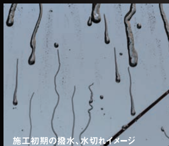
施工初期の撥水、水切れイメージ
